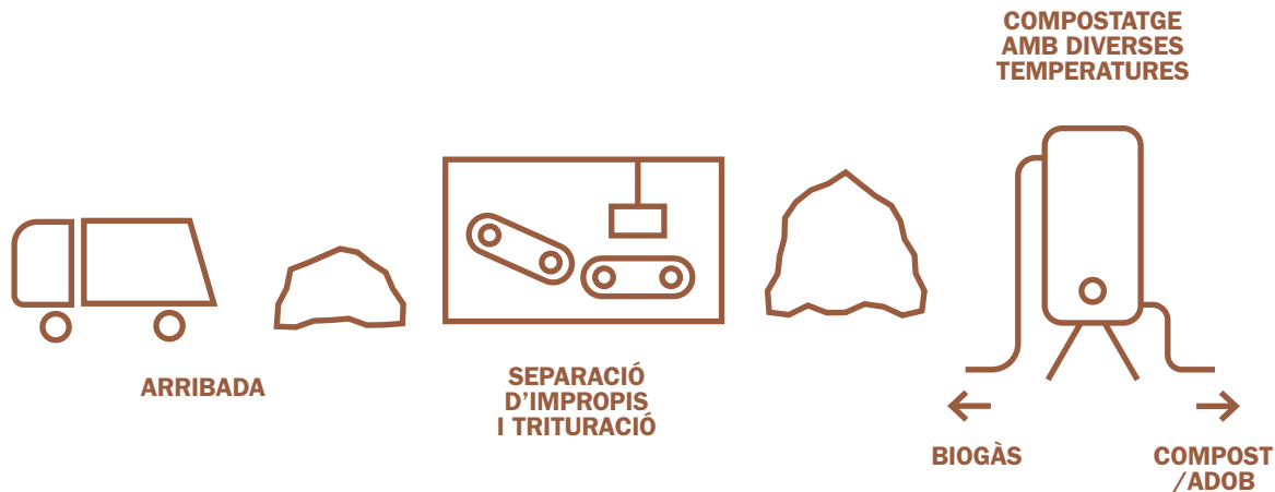
Figura 16. Línia de tractament de la FORM, residus orgànics, en un planta de compostatge. Elaboració pròpia.
